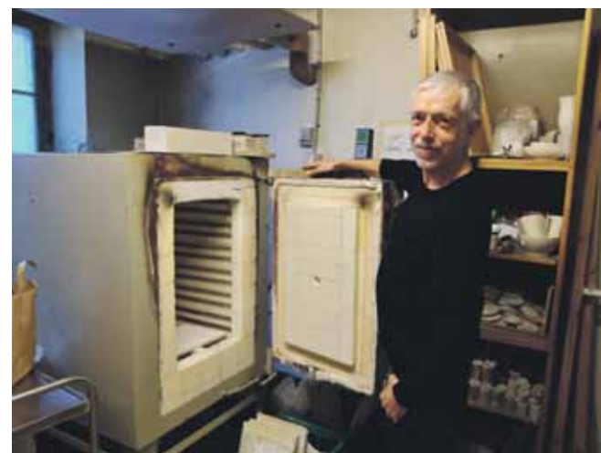
Henrik Christensen viser, hvordan lågen i den gamle ovn er eroderet væk, pga. saltindholdet i luften på Christianshavn. Nu samles brugerne på værkstedet om at rejse penge til en ny ovn via en auktion.
