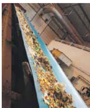
Her ses transportbåndet, hvor bioaffaldet, der ikke kan komposteres, frasorteres til forbrænding. Det udgør ca 6% af madaffaldet.
